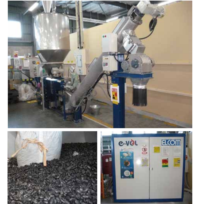
(写真上)熱可塑性樹脂減容機(ペレタイザー)、(写真左下)製造されたペレット、(写真右下)樹脂系固形燃料ボイラー
